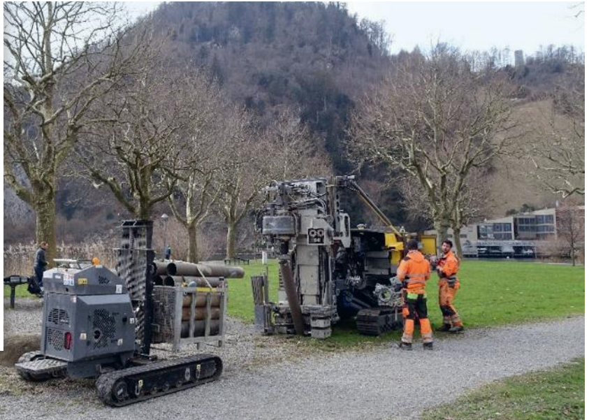
Bild: Dreh-Rammkernsondierungen in der Garnhänki. Fachstelle Archäologie Nidwalden.
